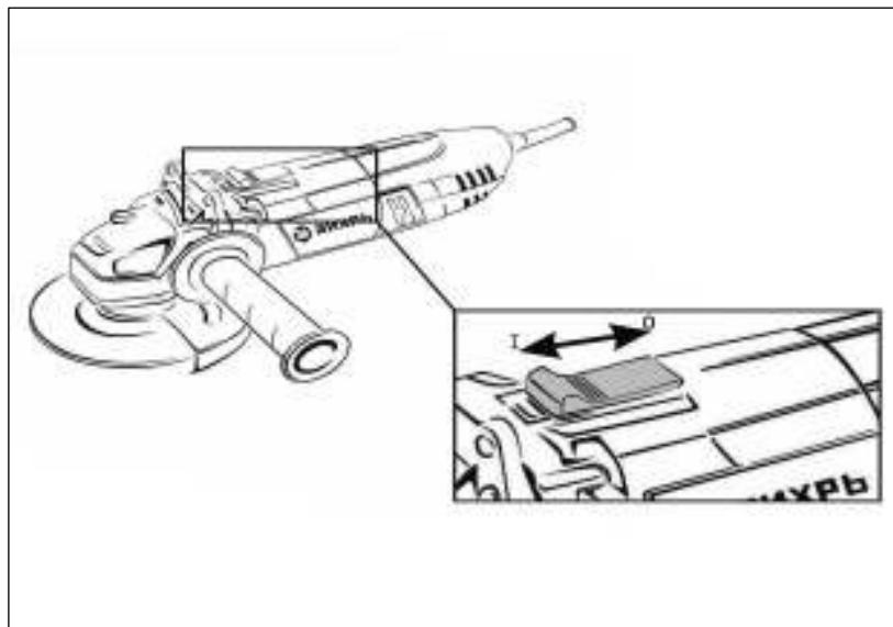
Рис.7 Клавиша включения (УШМ-115/650, УШМ-125/900, УШМ-125/1100)
