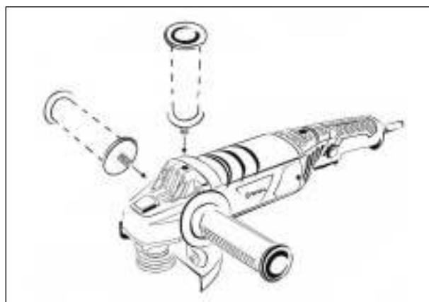
Рис.5 Установка боковой рукоятки
