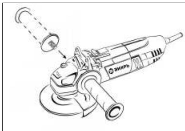
Рис.4 Установка боковой рукоятки
