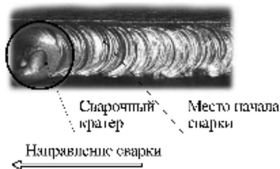
Рис. 7.5. Начало сварки при смене электрода.
