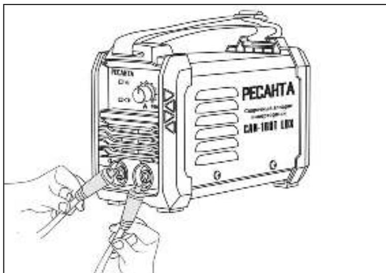
Рис. 4. Подключение кабелей
