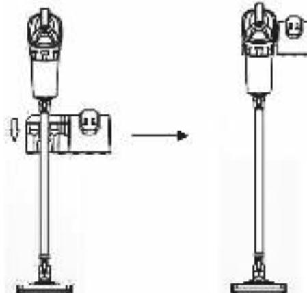
2. Есть возможность заряжать аккумулятор отдельно. Это удобно, если у вас несколько батарей. Нажмите на кнопку фиксатора и извлеките аккумулятор из пылесоса.
