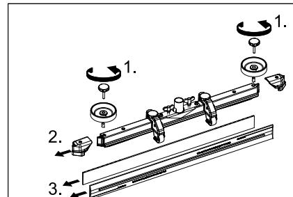
→ Снять пластмассовые элементы.
