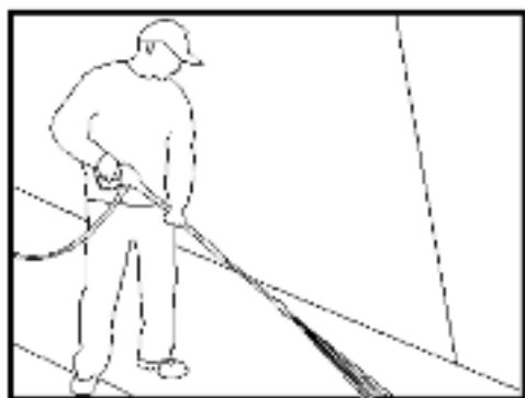
Рис. 6 - Оптимальный угол распыления воды относительно поверхности
