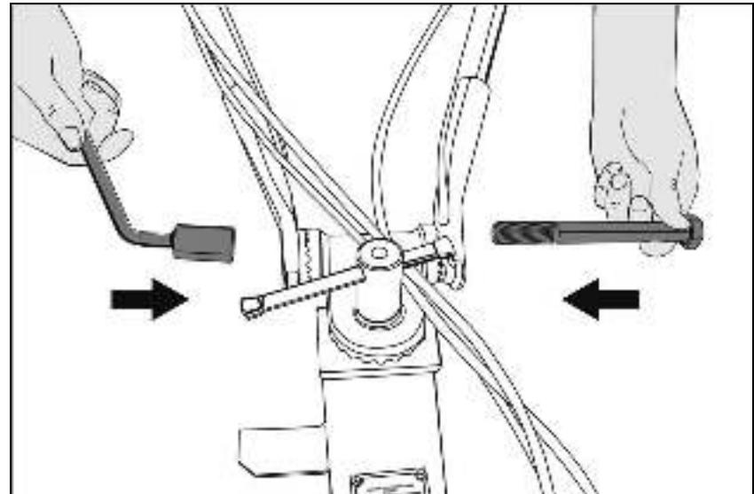
Рис. 3 «Фиксация рукоятки управления»
