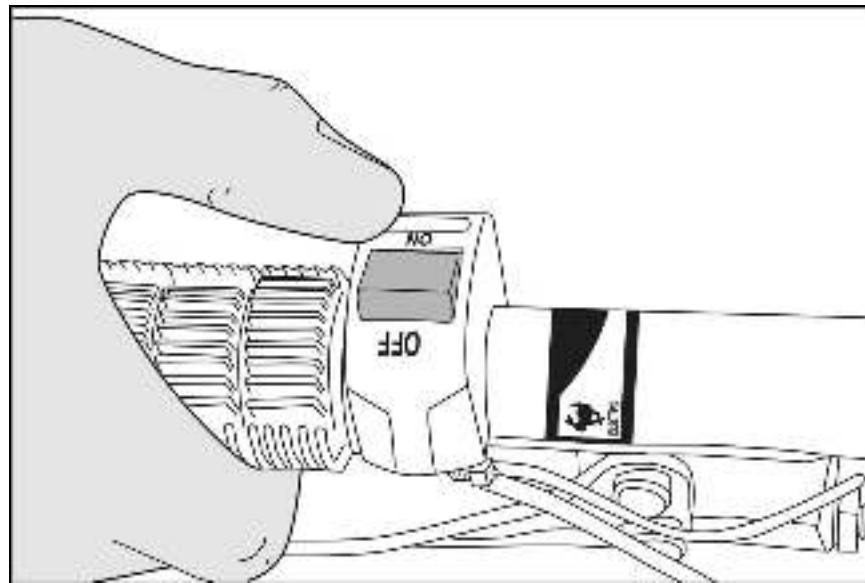
Рис. 23 «Включение зажигания»
