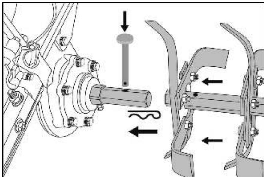
Рис. 6 «Установка фрезы»
