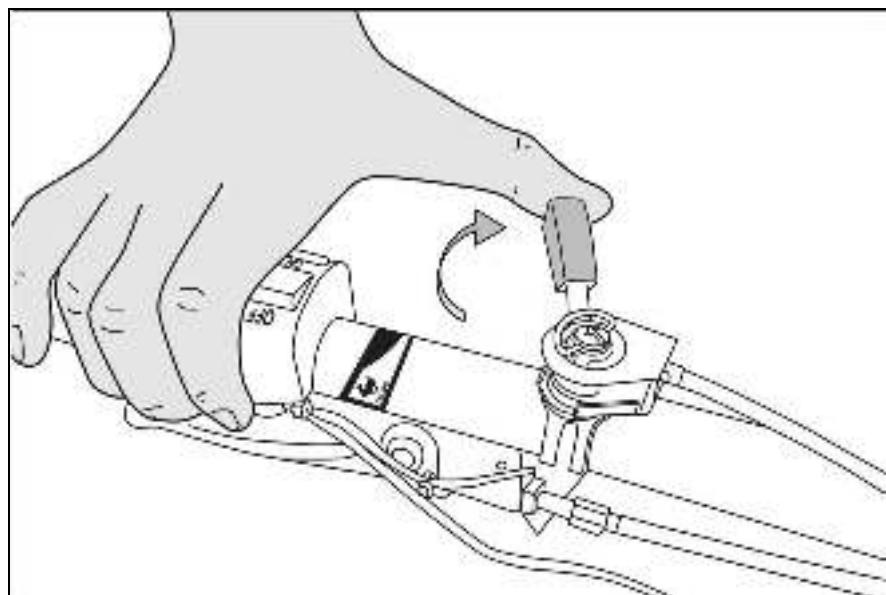
Рис. 30 «Установка рычага газа в минимальное положение
