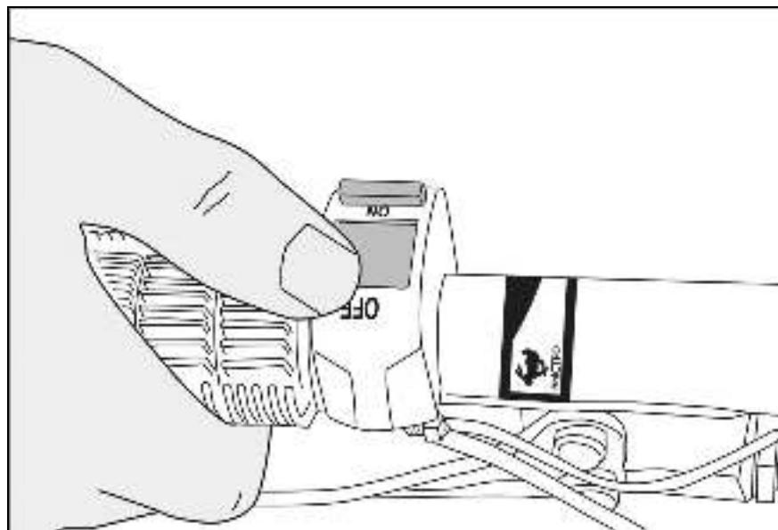
Рис. 29 «Выключение зажигания»
