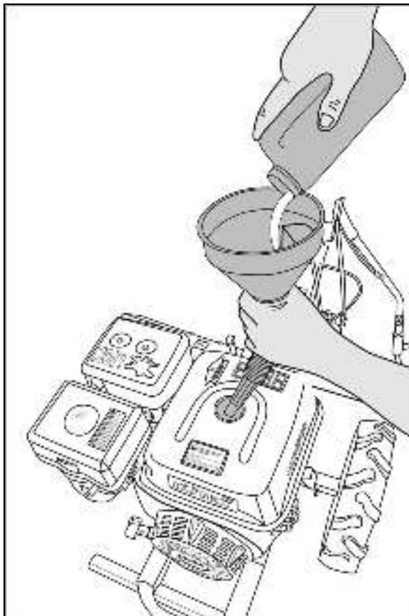
Рис. 20 «Заливка бензина»
