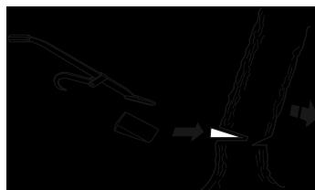
Мы рекомендуем пользоваться шиной пилы, длина которой бы превышала диаметр ствола, чтобы валящий и направляющий срезы могли выполняться т.н. "одинарным срезом". См. указания в разделе Технические данные, относительно рекомендуемой длины шины пилы для Вашей модели моторной пилы.
