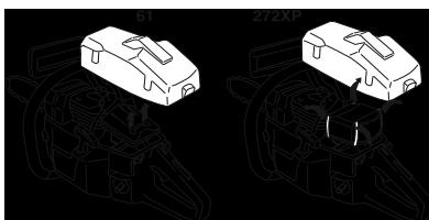
Для более тщательной чистки фильтр следует помыть в воде с мылом.
