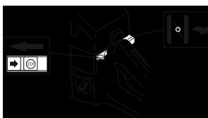
Если машина оборудована декомпрессионным клапаном (A): Его необходимо нажать, чтобы уменьшить давление в цилиндре и облегчить запуск машины. При запуске машины всегда пользуйтесь декомпрессионным клапаном. После запуска машины он автоматически вернется в свое первоначальное положение.
