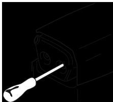
В некоторых глушителях предусмотрен специальный искрогаситель. Если ваша машина оборудована таким глушителем, сетку фильтра следует чистить раз в неделю. Наилучшие пользоваться стальной щеткой. Забитая решетка приводит к работе с горячим двигателем, что дает серьезные повреждения двигателя.
