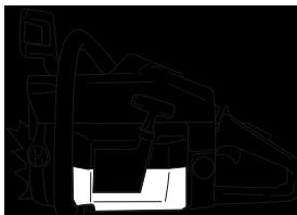
**ВАЖНО!** При повышении температуры выше -5°C и соответственно 0°C машине пила ДОЛЖНА быть отрегулирована для работы в нормальных условиях. Иначе может произойти перегревание, последствием которого может быть сильное повреждение двигателя.
