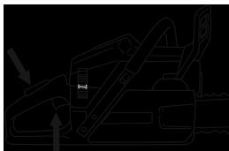
После того, как двигатель сделает первую вспышку, верните сразу рычаг воздушной заслонки в первоначальное положение, открывая воздушную заслонку, и повторите запуск. Когда двигатель запустится, дайте полный газ и отпустите рычаг дроссельной заслонки и блокировку пускового положения дроссельной заслонки отключится.
