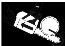
8 Если в этот момент не прикладывать достаточного противодействующего усилия, то возникает риск того, что моторная пила продвинется назад настолько, что дерева будет касаться только зона отдачи полотна, в этот момент может произойти отдача.
