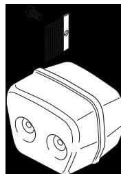
Глушитель служит для снижения уровня шума и отвода раскаленных выхлопных газов от рабочего. Выхлопные газы очень горячие и могут содержать искры, что может привести к пожару при прямом попадании на сухой и воспламеняющийся материал.
