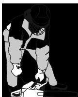
Так как тормоз цепи по-прежнему включен, двигатель должен как можно скорее быть переведен на холостые обороты, что может быть достигнуто за счет быстрого выключения ограничителя газа. Тем самым Вы избежите ненужного износа сцепления, барабана сцепления и тормозной ленты.
