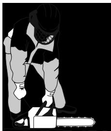
Твердо возмите моторную пилу, обхватив ручки всей ладонью.
