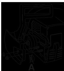
Установите пильное полотно на специально предназначенные болты. Установите полотно в самое заднее положение. Оденьте цепь на ведущую звездочку и вставьте ее хвостовики в паз пильного полотна. Начинайте с верхней стороны пильного полотна. Убедитесь, что кромки режущих энььев направлены вперед на верхней стороне пильного полотна.
