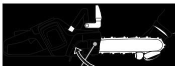
При установки новой цепи следует часто проверять ее натяжение, пока цепь не приработается. Регулярно проверяйте натяжение цепи. Регулярно проверяйте натяжение цепи. Правильно натянутая цепь обеспечивает высокое качество пиления и дольше служит.
