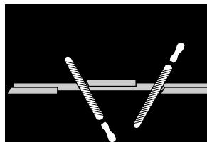
Отрегулируйте разводку. Она должен составлять 1 мм.
