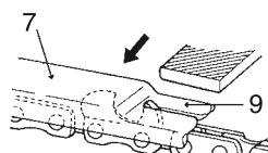
7. Контроль за высотой определяет, насколько крупные опилки производят бензопила. Правильную высоту ограничителей следует поддерживать в течение всего периода эксплуатации изделия.
