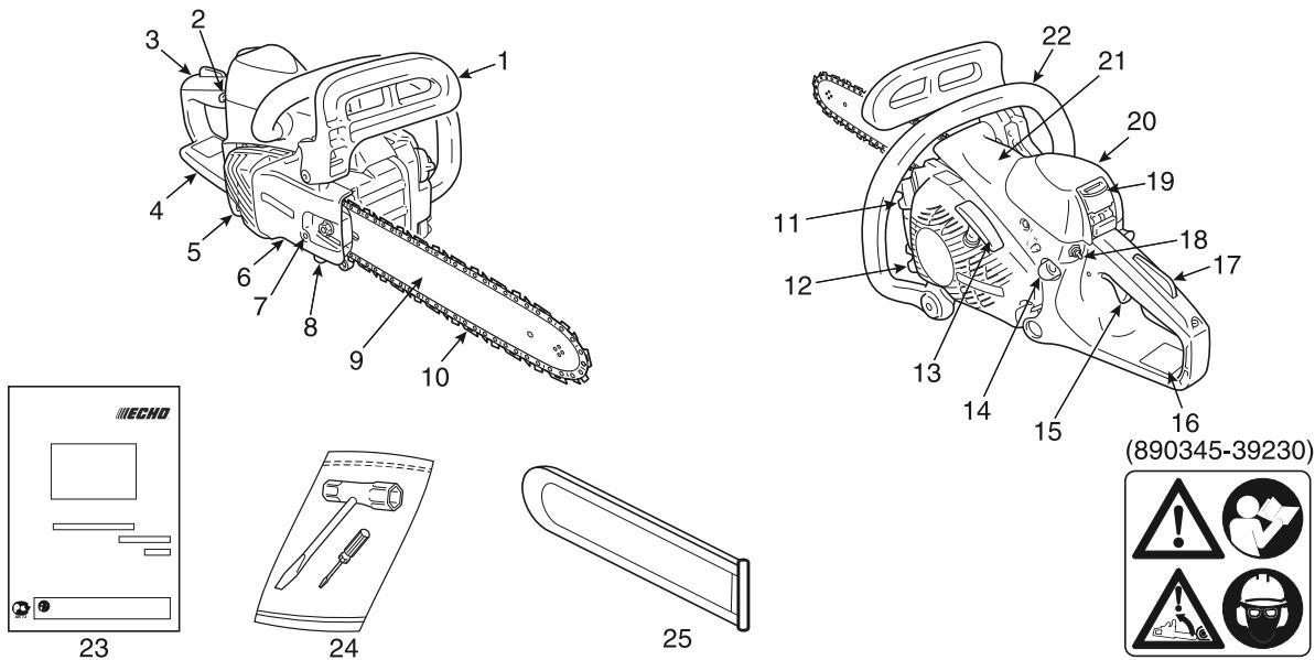
1. **Передний защитный щиток** - Щиток между передней ручкой пилы и пильной цепью, предназначенный для защиты руки от травм и помогающий обеспечить контроль над бензопилой в случае, если рука соскользнет с ручки. Этот щиток используется для активизации тормоза цепи, который предназначен для остановки вращения пильной цепи.
