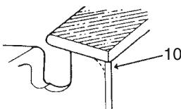
11. Ведущее звено служит для отвода опилок из канавки пильной шины.
