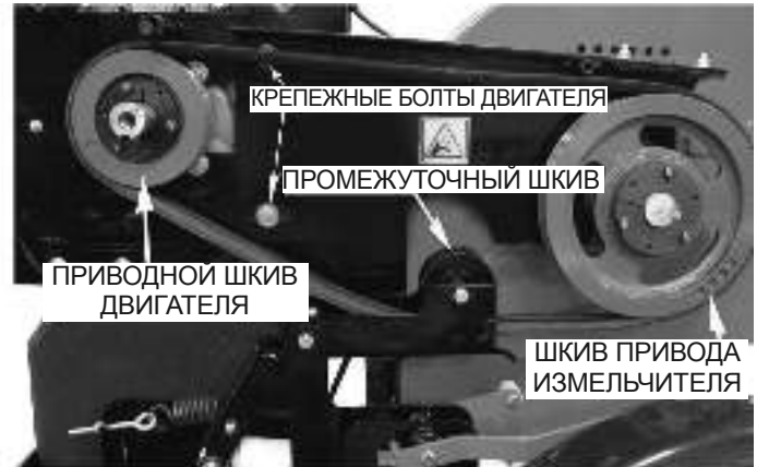
Рис. 5.7. Приводной ремень и шкивы.
