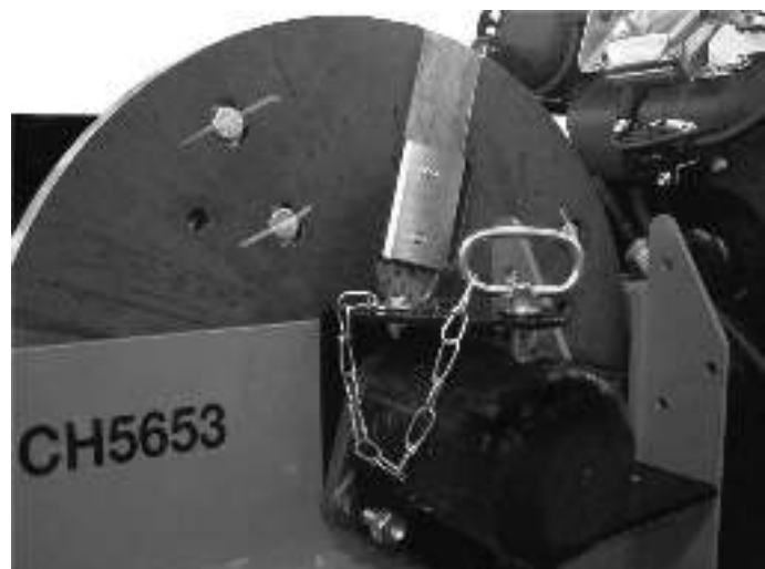
Рис. 5.2. Блокировочный штифт, фиксирующий ротор
