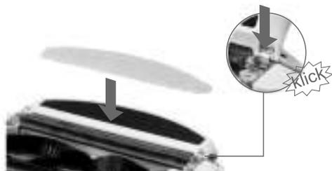
Установка моющей панели для протирания пола
