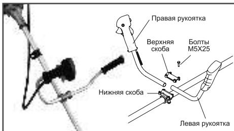
Рис.4 Установка рукояток
