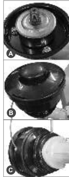
Рис. 6 Установка триммерной головки
