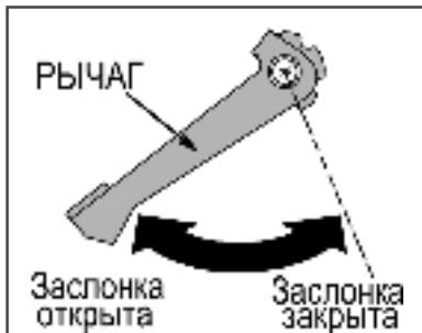
Рис. 14 Рычаг управления воздушной заслонкой PC5332F (вид сверху)
