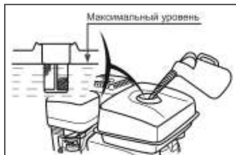
Рис. 13 Максимальный уровень топлива в топливном баке
