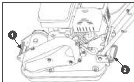
**Рис. 36 Рукоятки транспортировочные**
