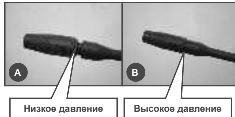
**Рис. 12 Положения головки струйной трубы**
