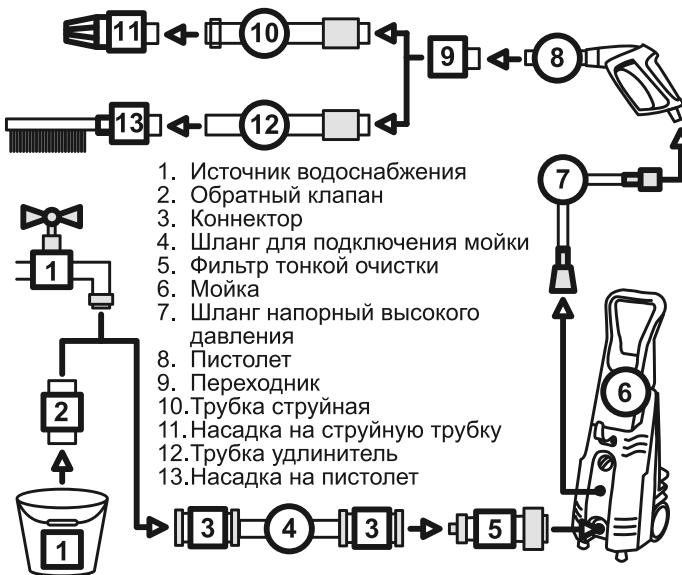
Рис. 13 Схема подключения аппарата с дополнительным оборудованием
