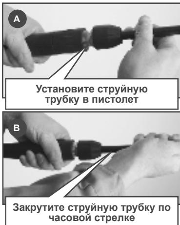
Рис. 5 Установка струйной трубы на пистолет
