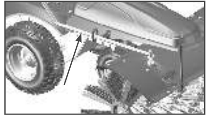
Рис. 11 Изменение угла поворота щетки
