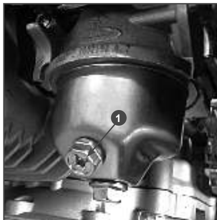
Рис. 23 Слив топлива из карбюратора
