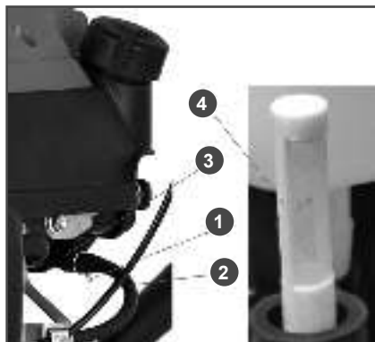
Рис.20 Чистка фильтра топливного бака
