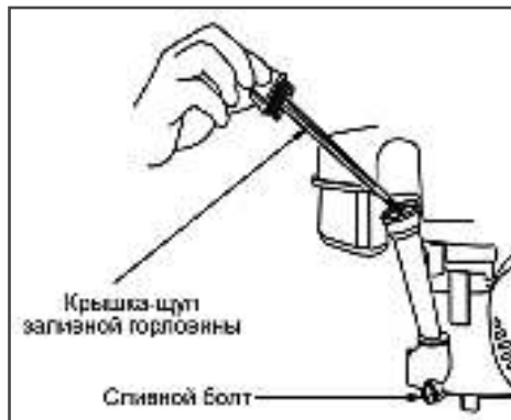
Рис. 18 Замена моторного масла
