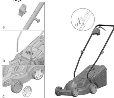
Рис. 4 Установка рабочих рукояток и колес
