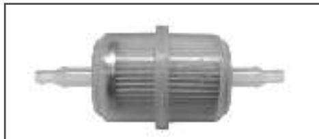
Рис. 22 Проточный топливный фильтр
