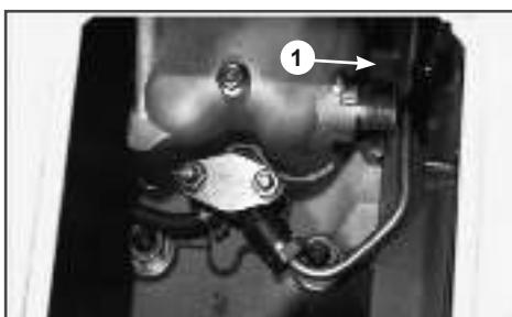
Рис. 13 Рычаг декомпрессора
