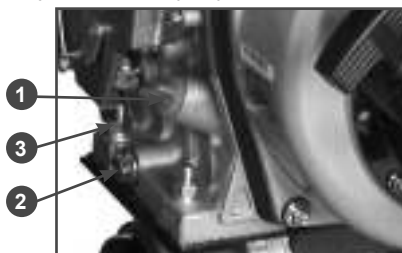
Рис. 10 Проверка уровня масла в картере
