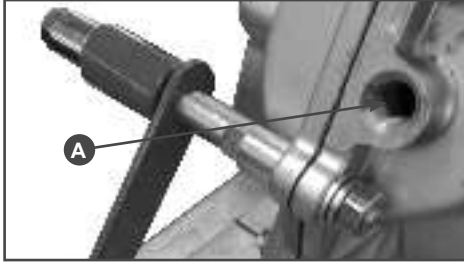
Рис. 10 Заправка масла в коробку передач
