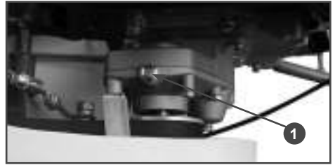
Рис. 11 Заправка масла в редуктор двигателя
