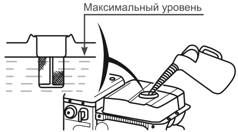
Рис. 11 Максимальный уровень топлива в топливном баке
