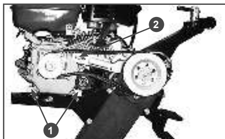
Рис. 8 Регулировка натяжения ремня привода
