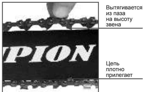
Рис. 6 Регулировка натяжения цепи
