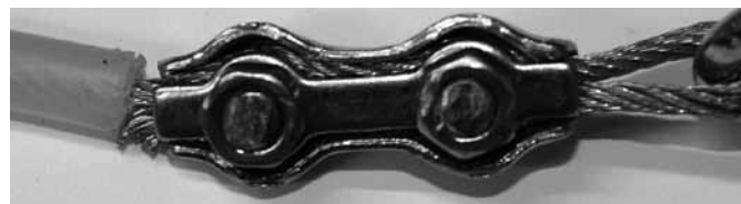
Изобр. 9 Регулировка троса. Регулировка под чулком (изображение сверху). Чулок удалён (изображение внизу).
