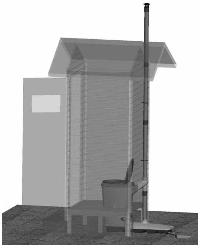
Изображение примера установки туалета и размещения канистры для сбора фильтрата
