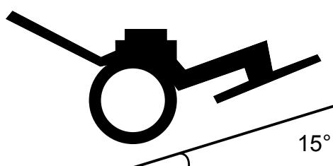
Не работайте на склонах с углом наклона более 15°. В противном случае произойдет выход двигателя из строя из-за недостаточной смазки, что не будет являться гарантийным случаем.
