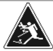
5. Ротор будет продолжать вращения после его расцепления. Выключите машину и подождите, пока все движущиеся детали не остановятся полностью прежде, чем приступать к осмотру или обслуживанию какого-либо узла машины. Отсоедините аккумулятор и выньте ключ зажигания, если он предусмотрен.
