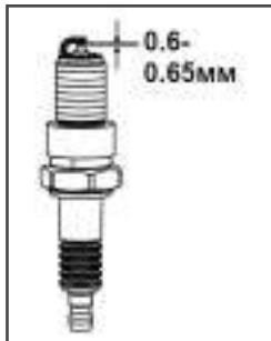
Рис.13 Свеча зажигания
