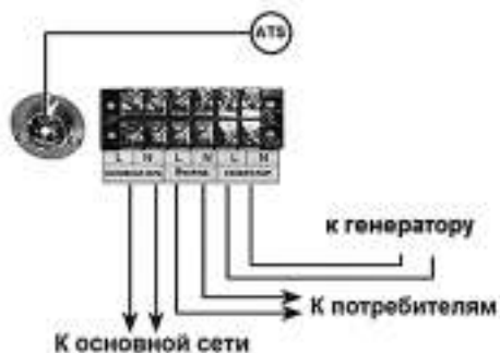
Рис. 15 Схема подключения блока ATS
