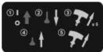
Рис. 10 Алгоритм запуска двигателя
