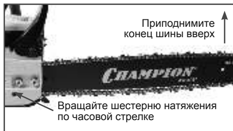
Рис. 5 Регулировка натяжения цепи
